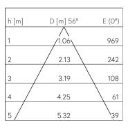
LED 3000 K 10 W 761 lm-h 56° / CIE Flux 95 100 100 100 100 / A80 nach DIN 5040
