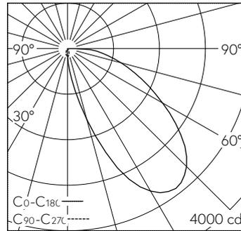
LED 4000 K 47 W 2354 lm-h / CIE Flux 37 73 92 100 100 / A30 nach DIN 5040
