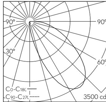
LED 3000 K 47 W 2187 lm-h / CIE Flux 37 73 92 100 100 / A30 nach DIN 5040
