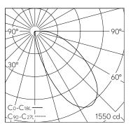
LED 2700 – 6500 K 29 W 966 lm-h / CIE Flux 37 73 92 100 100 / A30 nach DIN 5040
