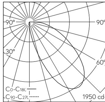
LED 2700 K 24,7 W 1213 lm-h / CIE Flux 37 73 92 100 100 / A30 nach DIN 5040
