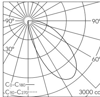
LED 3000 K 35,1 W 1722 lm-h / CIE Flux 37 73 92 100 100 / A30 nach DIN 5040
