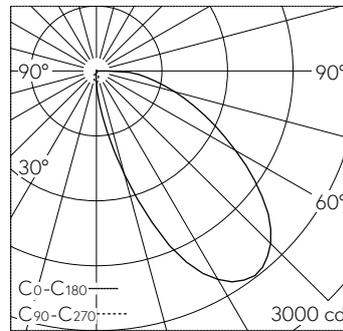
LED 2700 K 41,4 W 1812 lm-h / CIE Flux 37 73 92 100 100 / A30 nach DIN 5040
