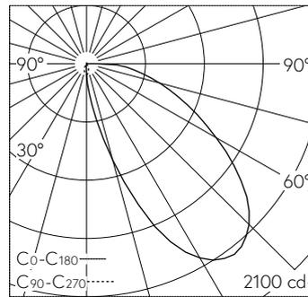
LED 3000 K 25,5 W 1317 lm-h / CIE Flux 37 73 92 100 100 / A30 nach DIN 5040
