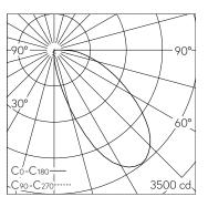
LED 4000 K 41,4 W 2116 lm-h / CIE Flux 37 73 92 100 100 / A30 nach DIN 5040
