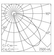
LED 2700 K 35,1 W 1586 lm-h / CIE Flux 37 73 92 100 100 / A30 nach DIN 5040
