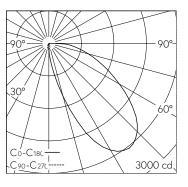
LED 4000 K 34,1 W 1853 lm-h / CIE Flux 37 73 92 100 100 / A30 nach DIN 5040
