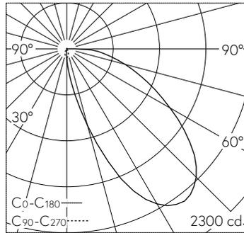
LED 3000 K 35.40 W 1459 lm-h / CIE Flux 37 73 92 100 100 / A30 nach DIN 5040
