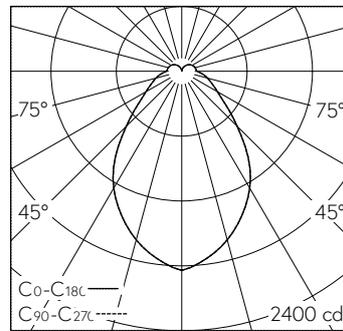
LED 3000 K 43 W 4303 lm-h / CIE Flux 55 79 92 85 100 / B51 nach DIN 5040
