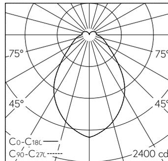
LED 4000 K 47 W 4526 lm-h / CIE Flux 55 79 92 85 100 / B51 nach DIN 5040
