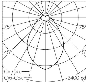
LED 4000 K 43 W 4526 lm-h / CIE Flux 55 79 92 85 100 / B51 nach DIN 5040
