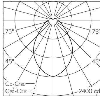
LED 2700 – 6500 K 43 W 4191 lm-h / CIE Flux 55 79 92 85 100 / B51 nach DIN 5040
