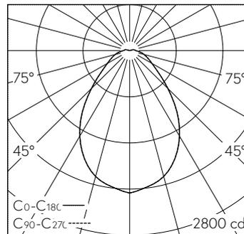
LED 2700 – 6500 K 47 W 4363 lm-h / CIE Flux 59 83 94 96 100 / A50 nach DIN 5040
