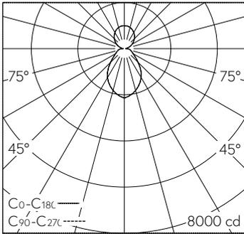
LED 4000 K 68 W 6936 lm-h / CIE Flux 55 79 92 61 100 / B53 nach DIN 5040
