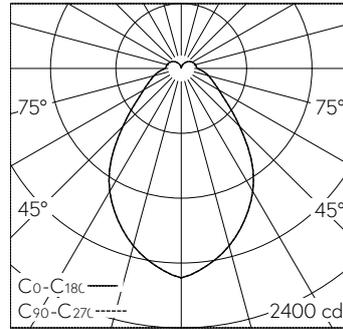
LED 4000 K 68 W 6936 lm-h / CIE Flux 55 79 92 85 100 / B51 nach DIN 5040
