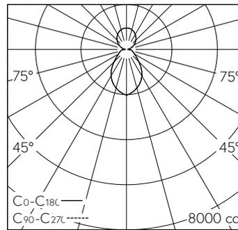
LED 3000 K 72 W 6562 lm-h / CIE Flux 55 79 92 61 100 / B53 nach DIN 5040
