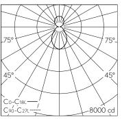
LED 3000 K 72 W 6562 lm-h / CIE Flux 55 79 92 61 100 / B53 nach DIN 5040
