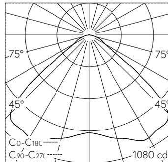
LED 2700 K 36 W 2622 lm-h / CIE Flux 58 92 98 99 100 / A50 nach DIN 5040
