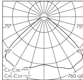
LED 2700 K 37 W 1832 lm-h / CIE Flux 58 92 98 99 100 / A50 nach DIN 5040
