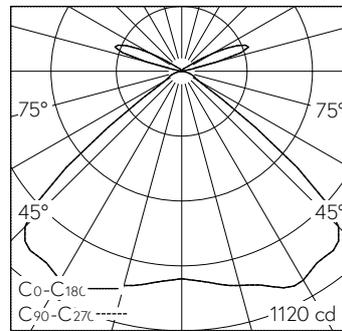
LED 3000 K 36 W 3019 lm-h / CIE Flux 63 96 99 83 100 / B61 nach DIN 5040
