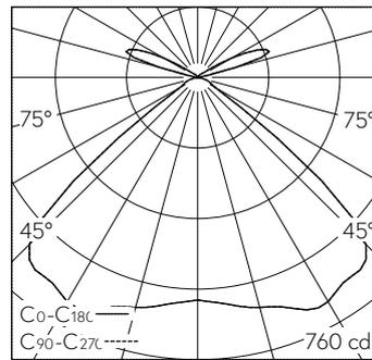
LED 2700 K 37 W 2021 lm-h / CIE Flux 63 96 99 83 100 / B61 nach DIN 5040
