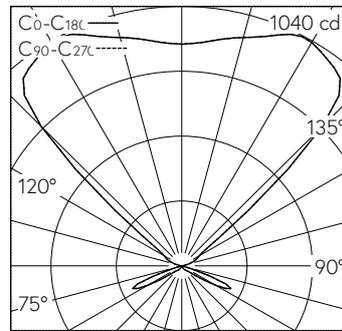
LED 2700 K 38 W 2589 lm-h / CIE Flux 5 34 99 13 100 / D14 nach DIN 5040
