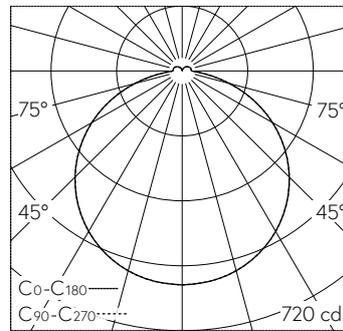
LED 3000 K 22.2 W 1939 lm-h / CIE Flux 45 76 94 94 100 / A41 nach DIN 5040
