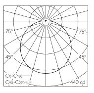
LED 2700 K 16.8 W 1272 lm-h / CIE Flux 42 71 89 91 100 / A31 nach DIN 5040
