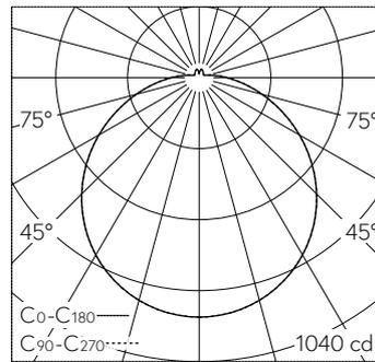
LED 2700 K 29.4 W 2990 lm-h / CIE Flux 43 73 91 93 100 / A31 nach DIN 5040
