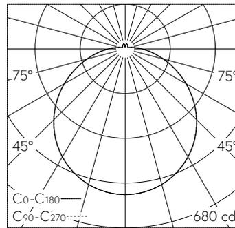
LED 3000 K 21.5 W 1890 lm-h / CIE Flux 43 73 91 93 100 / A31 nach DIN 5040
