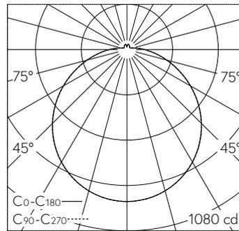
LED 3000 K 32.2 W 3088 lm-h / CIE Flux 43 73 91 93 100 / A31 nach DIN 5040
