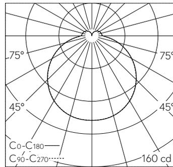
LED 2700 K 4.9 W 433 lm-h / CIE Flux 40 70 89 84 100 / B31 nach DIN 5040
