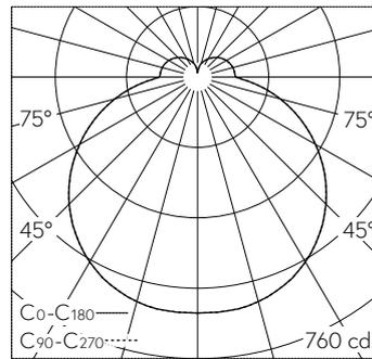
LED 2700 K 30.6 W 2976 lm-h / CIE Flux 39 68 88 80 100 / B31 nach DIN 5040
