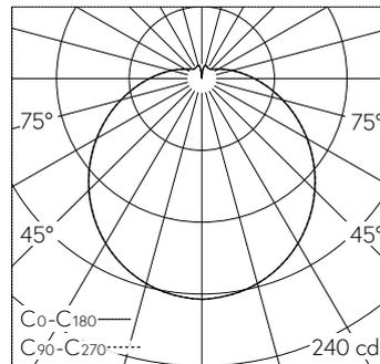
LED 3000 K 8.4 W 780 lm-h / CIE Flux 39 67 86 84 100 / B31 nach DIN 5040
