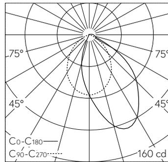
LED 3000 K 2.7 W 197 lm-h / CIE Flux 60 89 98 99 100 / A50 nach DIN 5040
