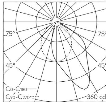
LED 4000 K 5 W 447 lm-h / CIE Flux 58 88 97 99 100 / A50 nach DIN 5040
