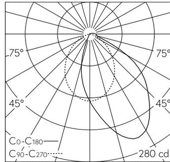
LED 3000 K 5 W 436 lm-h / CIE Flux 56 86 97 99 100 / A50 nach DIN 5040
