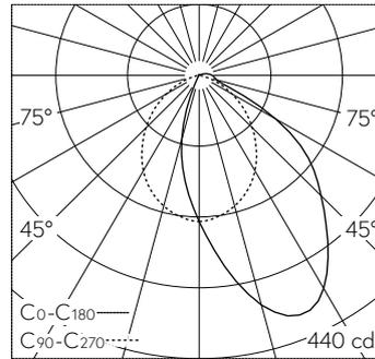
LED 3000 K 7 W 620 lm-h / CIE Flux 56 86 97 99 100 / A50 nach DIN 5040
