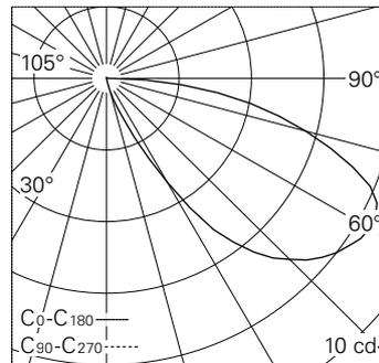
LED 3000 K 2.3 W 9 lm-h / CIE Flux 14 51 85 100 100 / A10 nach DIN 5040
