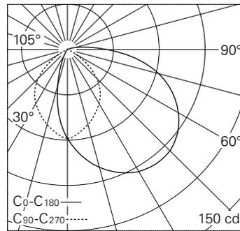
LED 3000 K 3.8 W 188 lm-h / CIE Flux 42 72 90 98 100 / A30 nach DIN 5040
