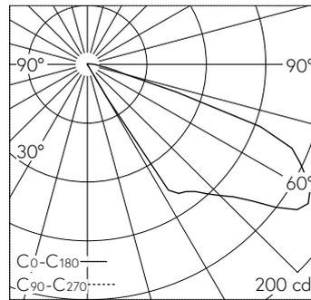
LED 4000 K 2.7 W 107 lm-h / CIE Flux 13 57 96 99 100 / A10 nach DIN 5040
