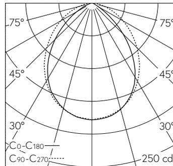
LED 3000 K 5.2 W 437 lm-h / CIE Flux 60 89 98 100 100 / A50 nach DIN 5040
