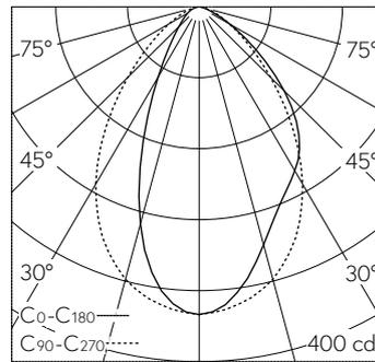
LED 3000 K 9 W 416 lm-h / CIE Flux 70 93 99 100 100 / A60 nach DIN 5040
