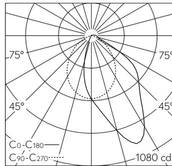
LED 3000 K 13.8 W 1179 lm-h / CIE Flux 58 88 97 99 100 / A50 nach DIN 5040
