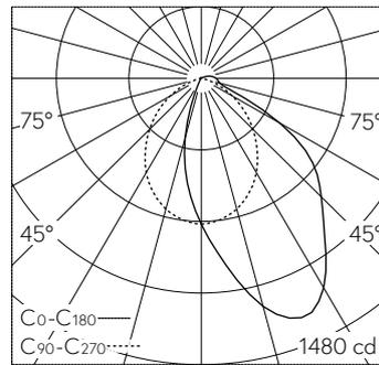
LED 4000 K 21 W 1775 lm-h / CIE Flux 56 86 97 98 100 / A50 nach DIN 5040
