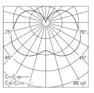
LED 3000 K 4.7 W 500 lm-h / CIE Flux 24 51 76 64 100 / B11 nach DIN 5040
