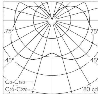
LED 4000 K 4.7 W 534 lm-h 248°/248° / CIE Flux 24 51 76 64 100 / B11 nach DIN 50...
