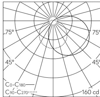
LED 3000 K 4.7 W 264 lm-h / CIE Flux 35 61 83 85 100 / B21 nach DIN 5040
