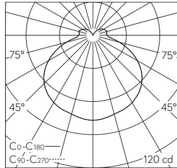
LED 4000 K 4.8 W 387 lm-h 128°/128° / CIE Flux 38 69 89 82 100 / B31 nach DIN 5...
