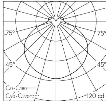
LED 3000 K 4.8 W 362 lm-h 128°/128° / CIE Flux 39 70 90 84 100 / B31 nach DIN 5...
