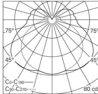
LED 3000 K 4.8 W 359 lm-h / CIE Flux 34 64 85 76 100 / B21 nach DIN 5040
